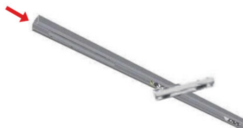
第二步：将上定位及上吊轮套上导轨
