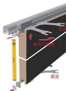
第五步：用扳手调节门高度，并保持门的水平，最后锁死固定
