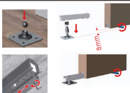
第三步：安装下定位及固定上定位配件，需与上定位配件保持垂直
