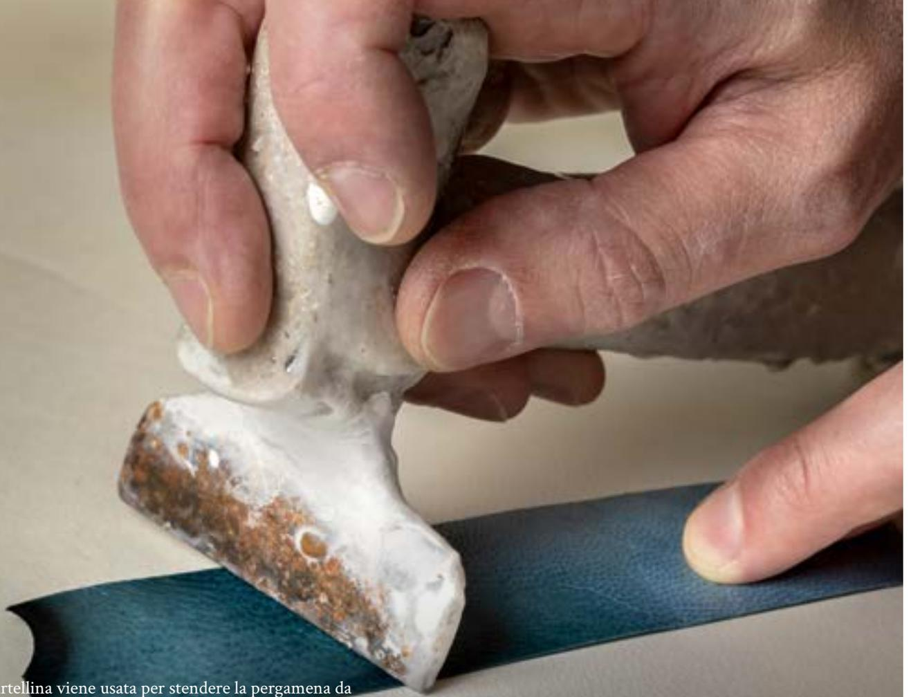
La martellina viene usata per stendere la pergamena da incollare. La complessa ergonomia del manico testimonia l'importanza della manualità necessaria nella lavorazione e nella posa delle pelli.
