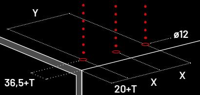
底部桌面-轨道顶底固定
